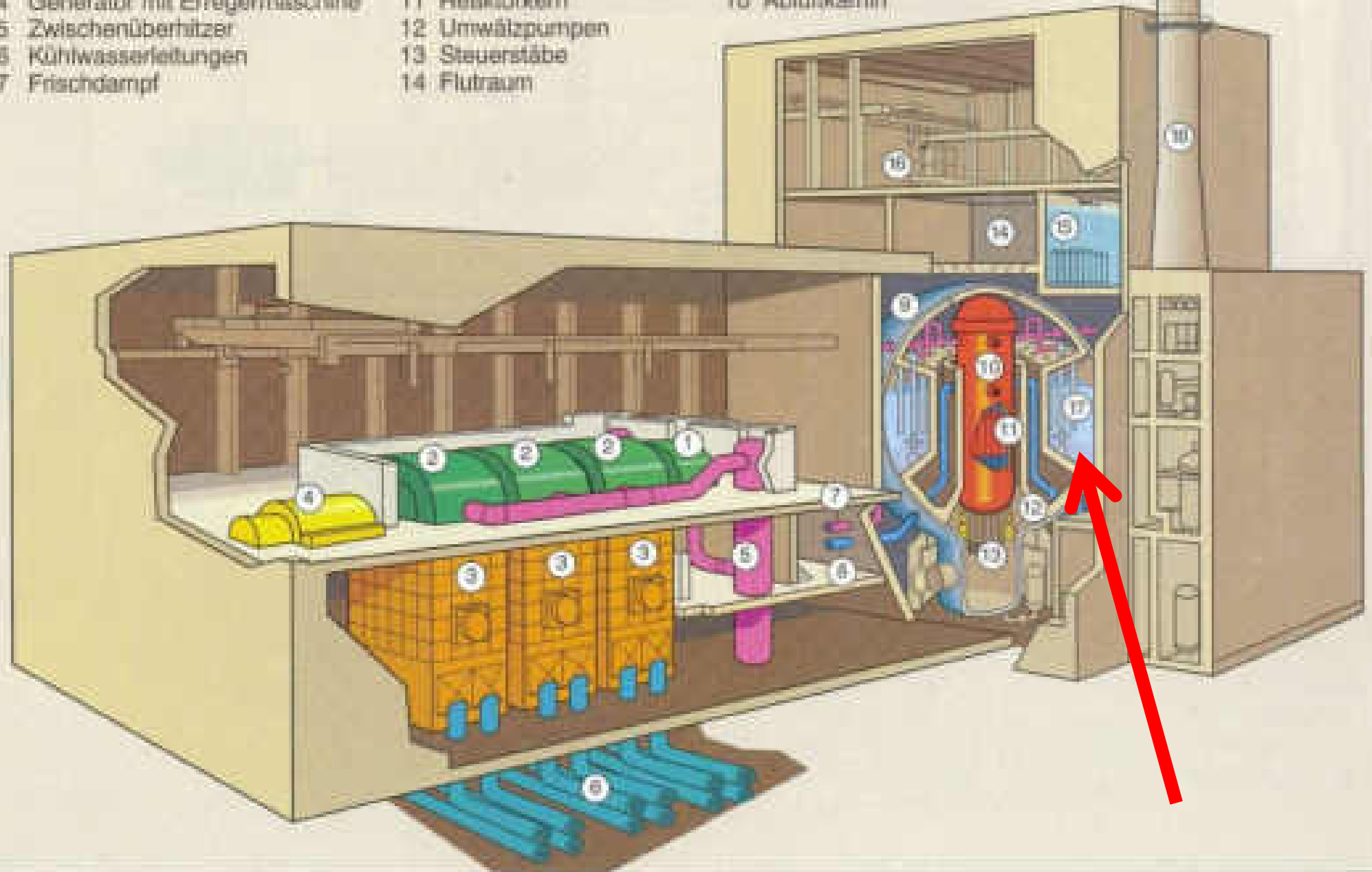
Abb. 6.1.2 Räumliche Anordnung wichtiger Komponenten im Kernkraftwerk Krümmel (vereinfachte Darstellung)
