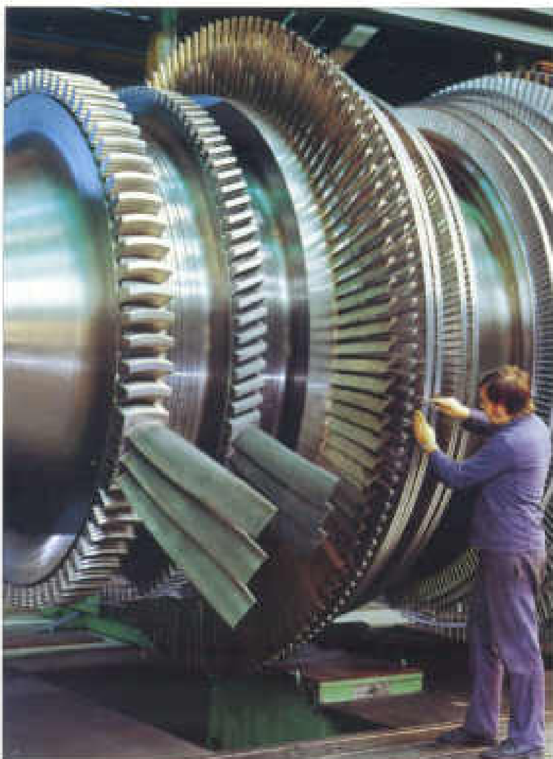
Dampf-Turbine (ähnlich Kohlekraftwerk)
